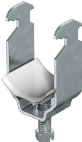
Passend zu allen C-Profileschienen mit 16 - 17 mm Schlitzweite. Schelle und Schraube aus tauchfeuerverzinktem Stahl, Druckwanne aus Polypropylen, halogenfrei, Farbe Lichtgrau RAL 7035. Ausführung mit Anschweiß- und/oder Kontermutter für Einsatz unter erschwerten Bedingungen sowie für Rüttelsicherheit auf Anfrage!
