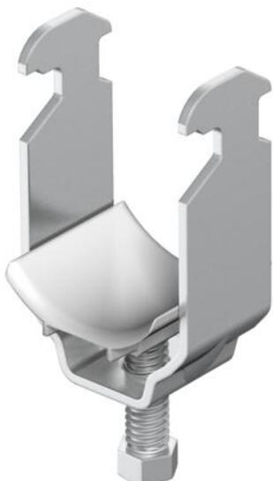
Passend zu allen C-Profileschienen mit 16 - 17 mm Schlitzweite. Schelle und Schraube aus Edelstahl. Druckwanne aus Polypropylen, halogenfrei, Farbe Lichtgrau RAL 7035.
