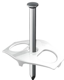
Mit vormontiertem, verzinkten Stahl Nagel Ø 3 mm oder 3,5 mm zur Fixierung von Leitungen in Mauerschlitzen und auf Mauerwerk für 1 bzw. 2 Leitungen NYM 3 x 1,5/2,5 mm<sup>2</sup> oder 1 bzw. 2 Leitungen NYM 5 x 1,5/2,5 mm<sup>2</sup>.
