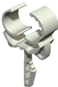
Mit angespritztem Steckdübel zur Schnellmontage in Betonwänden und Mauerwerk. Dübel bis zum Aufliegen der Schellenunterkante ins Bohrloch einstecken, beim Eindrücken des Rohres schließt und rastet die Schelle selbsttätig ums Rohr.
