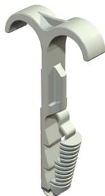
Die Steckschellen dienen zur Verlegung von Leitungen und Rohren an Wand und Decke und der Verlegung von flexiblen Rohren auf Beton und im Estrich. Die Doppelsteckschellen ersetzen Nagelclips in Beton und Gasbeton. Der Vorteil der Steckschellen liegt darin, dass sie nur in das Bohrloch gesteckt werden müssen. Es entfällt die Verwendung von Dübeln und Schrauben.
