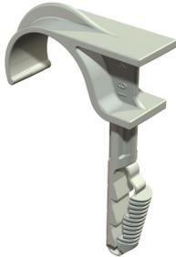
Die Steckschellen dienen zur Verlegung von Leitungen und Rohren an Wand und Decke und der Verlegung von flexiblen Rohren auf Beton und im Estrich. Die Einfachsteckschellen ersetzen Nagelclips in Beton und Gasbeton. Der Vorteil der Steckschellen liegt darin, dass sie nur in das Bohrloch gesteckt werden müssen. Es entfällt die Verwendung von Dübeln und Schrauben.
