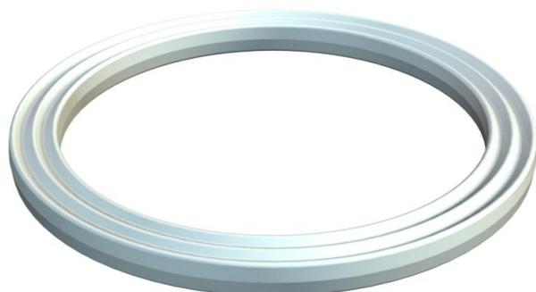
Anschlussgewinde-Dichtring ähnlich Teil 9 nach DIN 46320, Maße jedoch material- und funktionsbedingt zum Teil abweichend, geeignet für alle Kabelverschraubungen aus Kunststoff mit PG-Anschlussgewinde nach DIN 40430. Die Innendurchmesser der Dichtringe sind so ausgelegt, dass diese unverlierbar vormontiert werden können.
