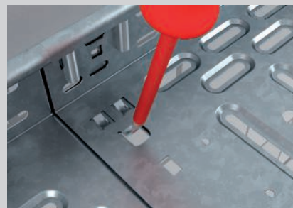
Schraubenlose Stoßstellenverbindung, nur Umbiegen der Bodenlaschen erforderlich.
