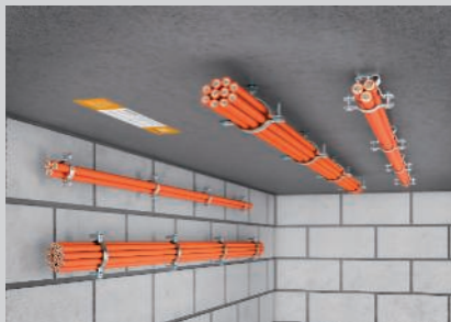
Gebündelte Kabelverlegung unter der Decke.
