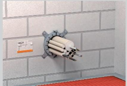
Gekennzeichnete Abschottung von Installationsrohrbündeln.
