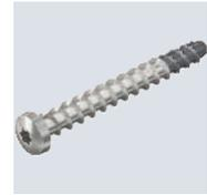
Edelstahl-Schraubanker zur direkten Montage ohne Dübel in gerissenem und ungerissenem Beton sowie Mauerwerk. Mit Rundkopf für universelle Befestigungen in Feuchträumen und Außenbereichen. Toxx-Antrieb T30. Gemäß EAD geprüft, CE-gekennzeichnetes Bauprodukt mit Europäisch Technischer Bewertung (ETA) und Anwendbarkeitsnachweis. Tragfähigkeiten unter Brandbelastung bis zur Feuerwiderstandsklasse R120 nachgewiesen.
