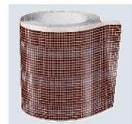
Selbstklebender, intumeszierender Kabelwickel, 5 mm dick, zum Einsatz bei großen Kabeldurchmessern und zur Anwendung auf durchgeführten Kabeltrag-Systemen; einsetzbar in den PYROPLUG® Systemen und PYROSIT® NG. Anwendung im Innenbereich.
