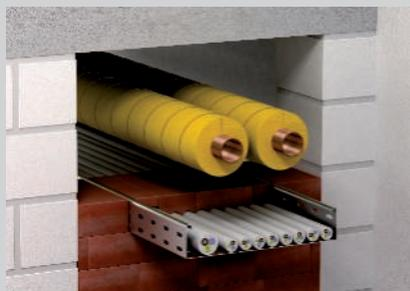
Durchgeführte nicht brennbare Rohre mit Streckenisolierung.
