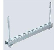
Abhänge- und Befestigungsmaterial aus Stahl zur Erstellung der ersten Unterstüzung von durchgeführten Installationen bei Brandabschottungen. Montage des Pendels mit Gewindestangen unter der Decke. Max. zwei Lagen können mit Verbindungsmuffen aus zwei Sets montiert werden. Die Stützkonstruktionen müssen beidseitig der Wand im vorgeschriebenen Abstand des Abschottungssystems angeordnet werden.
