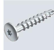
Schraubanker zur direkten Montage ohne Dübel in gerissenem und ungerissenem Beton sowie Mauerwerk. Mit großem Rundkopf für die Befestigung von Montage- und Profilschienen. Torx-Antrieb T30.
