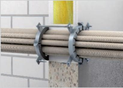
Beidseitige Anordnung der Rohrmanschetten bei Wandmontage.
