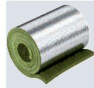
Mineralfolienmatten mit Aluminiumkaschierung für Streckenisolierungen an Kupfer- und Stahlrohren. Befestigung mit Wickeldraht, sichern der Stoßfugen mit Aluminiumklebeband.
